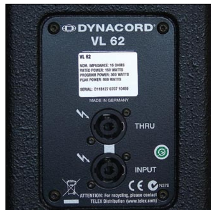
Tył obudowy posiada metalową płytkę, na której oprócz logo producenta i niezbędnych informacji znajdują się gniazda Speakon renomowanej firmy Neutrik.
