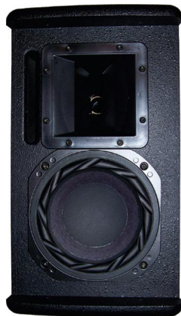
VL62 jest zestawem dwudrożnym. Po odkręceniu osłony głośników zauważyć można podłużny otwór bass-reflex.
